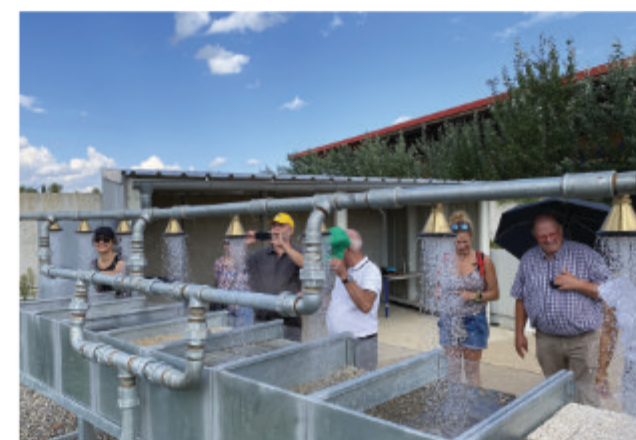
Démonstration des niveaux d'infiltration des matériaux à la Colmarienne des Eaux ©CAUE-Alsace
